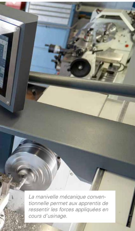
*La manivelle mécanique conventionnelle permet aux apprentis de ressentir les forces appliquées en cours d'usinage.*
